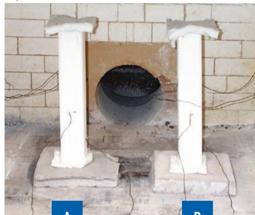
Columnas de acero a las que se les han aplicado revestimientos de la gama FIRETEX® FX, antes del ensayo de reacción al fuego
